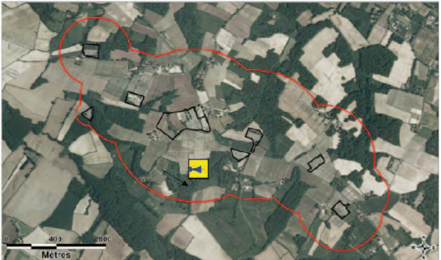
Photographie aérienne du site d'Izaute avec traçage de la zone PPI et emplacement de la sirène PPI (en **jaune fluo**) qui est une sirène électronique d'une puissance totale de **1800 W** composée de 12 diffuseurs sonores.
